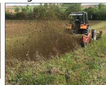
Kultivatorns tunna och skärande gäsfötter "skalperar" vallsvälarna. Rotorn lyfter upp fänggrödderna utan rötter till ytan och med eventuella ogräs för att sedan nedflyttas av yttskiktets mikrober och maskar. FOTO: BT Agro
