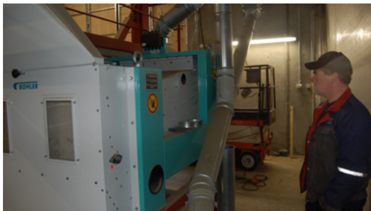
Utvecklingen går mot allt renare jordbruksprodukter. Den här spannmålssorteraren har en reningskapacitet på tio ton per timme, säger Roger Björknäs.
