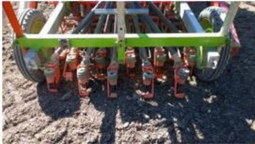
Försökssåmaskinen är inte gjord för sådd efter vall. Efter var och varannan ruta blir vi tvungna att rensa bort mellan såbillarna.
